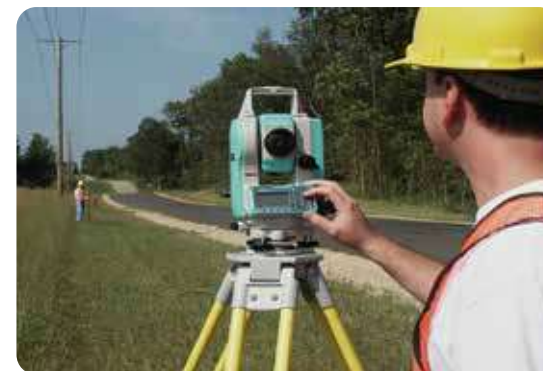
Тахеометр для визначення просторового положення елементів
