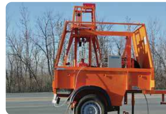
ДИНА-3М для вимірювання модуля пружності
