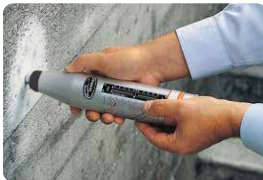
Склерометр для визначення міцності бетону
