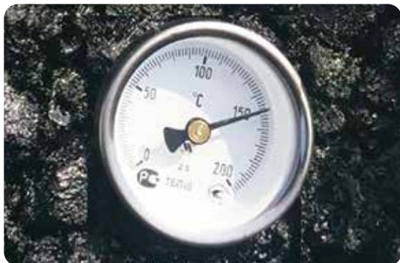
Контактний термометр для перевірки температури матеріалів
