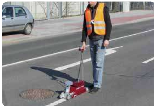
Ретрорефлектометр для перевірки дорожньої розмітки
