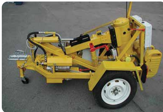
УДВО-НТУ для визначення показників рівності, міцності та зчеплення
