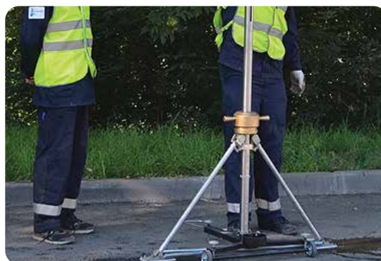
ППК-МАДИ для визначення коефіцієнту зчеплення
