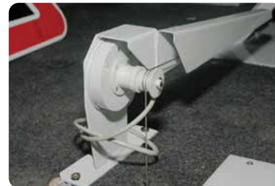
Поштовхмір для вимірювання рівності
