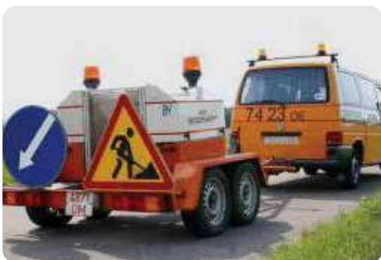
Дефлектометр для визначення міцності дорожнього одягу в русі
