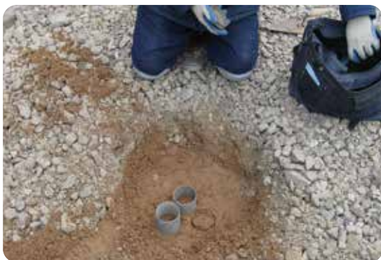
Ріжучі кільця для відбору проб ґрунту
