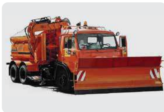
Комбінована дорожня машина (КДМ), обладнана відвалом та піскорозкидачем для зимового утримання
