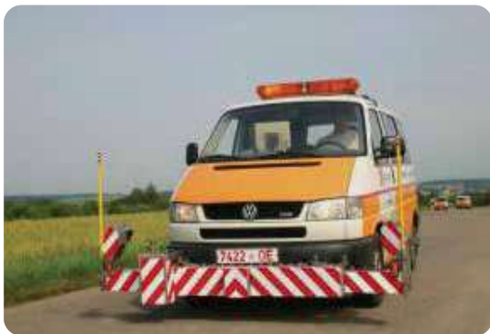
Профілограф для вимірювання рівності
